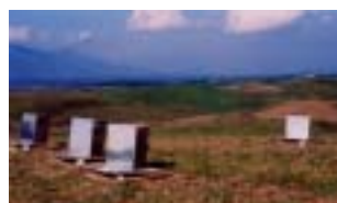
牧野に目印として設置したコーナーリフレクタ
